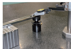
V溝アタッチメントを使用した丸棒測定
