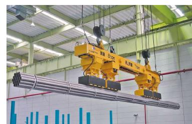
長尺の鋼材・丸棒・パイプを安全に吊り上げ出来る、LPR-VN専用の天秤（ビーム）を用途に合わせ製作致します。
