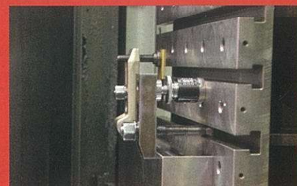
マグネット4極タイプの併用で、横型マシニングでの使用も可能。
