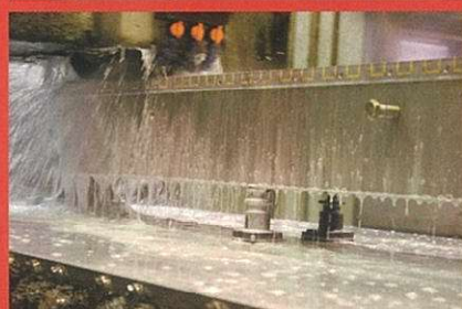
ワークのオーバーハング部や 研削加工時の中空部をサポート。
