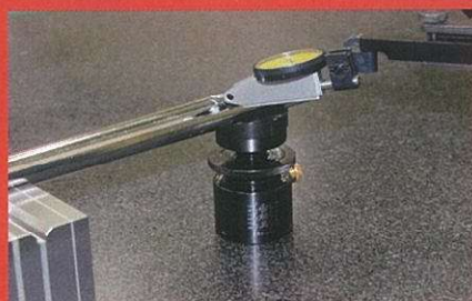
V溝アタッチメントを使用しての丸棒測定例。
