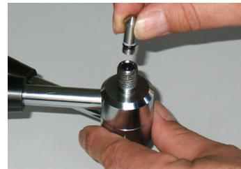
难以拔出时，请先适当拧松排气螺丝，然后一边旋转活塞 B 一边拔出。
