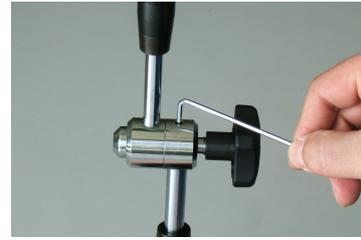
注意：如果拧紧固定旋钮后支柱的固定力仍然不足，说明内部有空气残留，请按照步骤 1 重新补油。此外，如果活塞 B 安装不当，可能导致辅助密封圈损坏，造成漏油。
