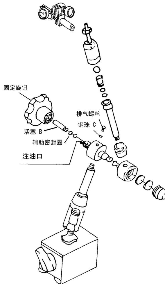
※新品时，为防止因温差导致油液膨胀而发生漏油，以及 O 型圈、辅助密封圈损坏，本品未完全注满油液。根据使用环境温度，可能在交付后 2~3 个月内出现紧固力下降的情况。此时请按上述方法注油并确认紧固效果。若紧固力仍不足，请通过购买时的经销商安排产品检测。
