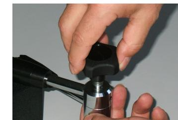
5. 重新竖起支柱，拧松排气螺丝后进行排气。待空气排尽后，请重新拧紧排气螺丝。
