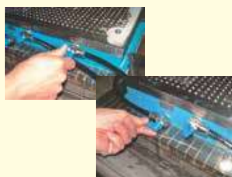
⑤加工完了後、吸引バルブを閉じ大気開放バルブを開きワークを取り外す。
