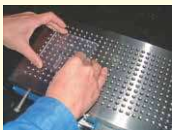
④ワークの固定を確認後、加工開始。
