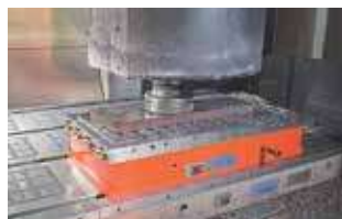
永電磁チャック機能を利用した フライス加工例
