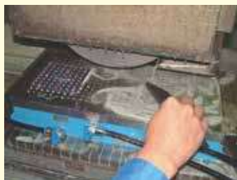
②加工液を全面に塗布する。
