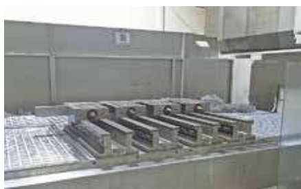
バイスを永電磁チャックで吸着・固定
