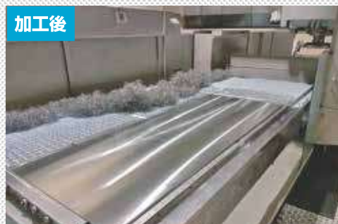
仕上げ後精度 平面度0.2mm 平行度0.04mm
