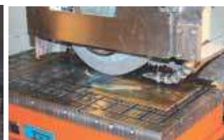
真空チャック機能を利用した 真ちゅう研削加工例
